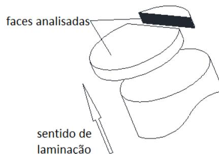
Figura 1 - Amostras obtidas a partir de barra cilíndrica do material ASTM F138.
