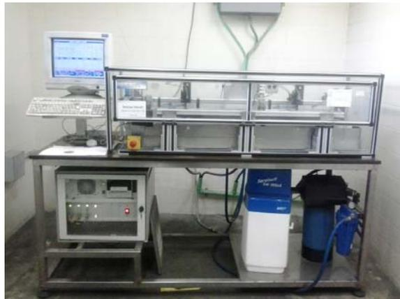
**Figura 3:** Balança hidrofílica do Laboratório de Folhas Metálicas da CSN, utilizada nessa pesquisa.
