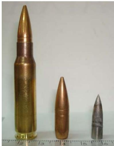
**Figura 1** – Projétil 7.62 Pf, encartuchado, desencartuchado e apenas o núcleo de aço.
