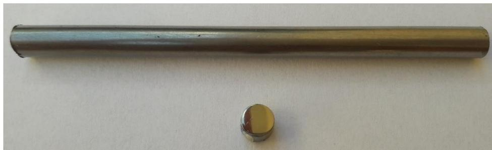
Figura 1. Amostra de Ti-30Nb.
