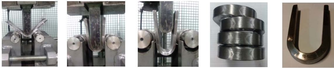
Figura 1. Sequência das etapas do ensaio de dobramento do aço API5LX70 na região da zona fundida (ZF).
