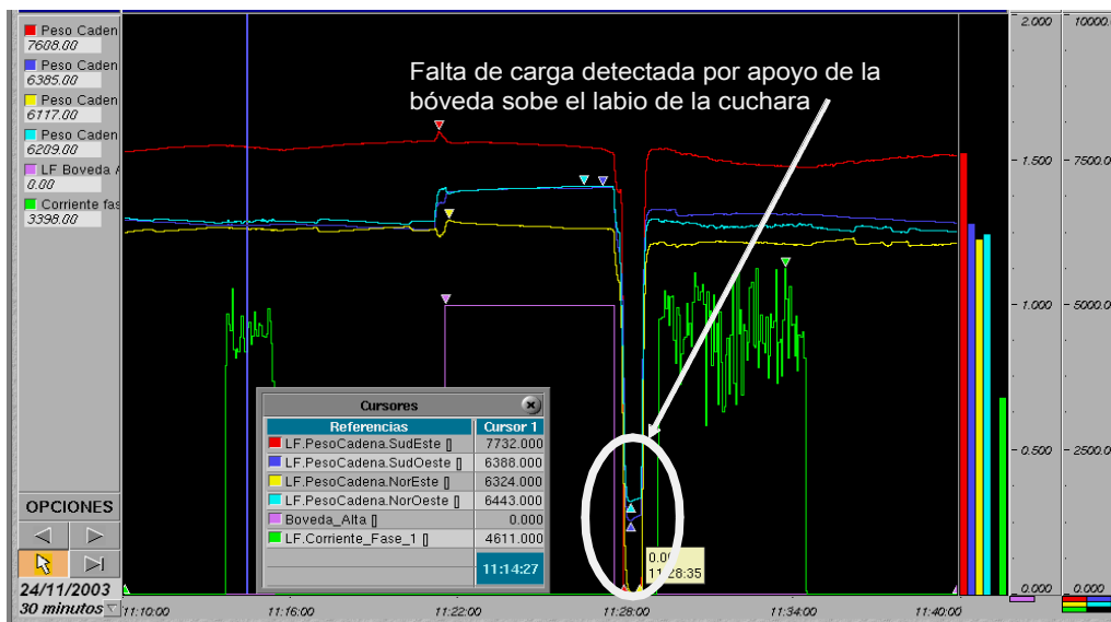
Figura 3. Sistema de detección de labio de cuchara sucio.
