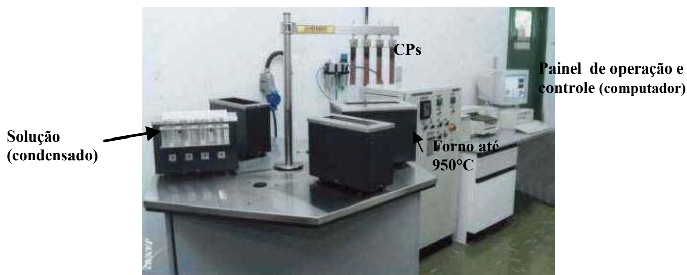
Figura 2. Foto do equipamento Dip Dry utilizado para simulação da corrosão cíclica .
