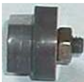
Figura 3. Detalhe da montagem do dispositivo para o ensaio de corrosão por frestas com material de zircônio.
