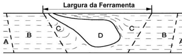
Figura 2 – Diferentes regiões ao longo da junta soldada.
