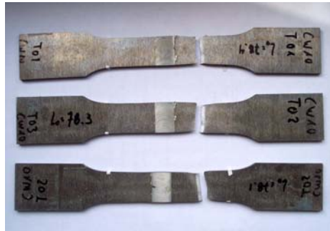
Figura 8 – Visão geral dos corpos de prova de tração mostrando o local de ruptura.
