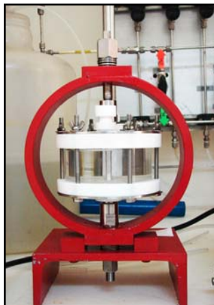
Figura 2 – Aspecto geral do dispositivo de ensaio de corrosão sob tensão.
