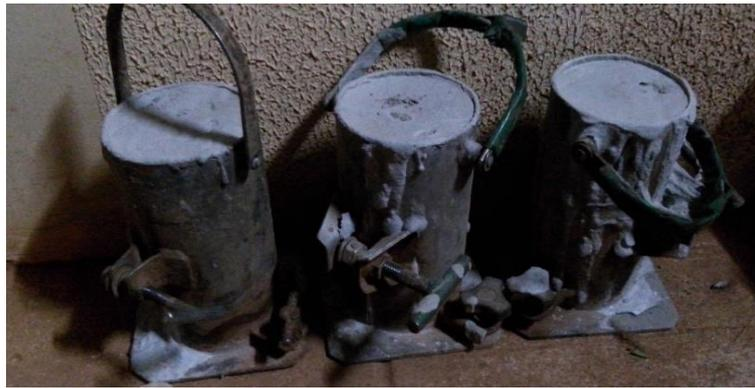
**Figura 4.** Corpos de prova moldados com concreto celular.
