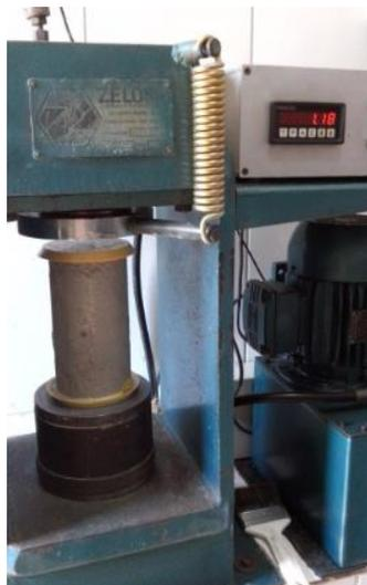
**Figura 5.** Rompimento de corpo de prova na prensa hidráulica.
