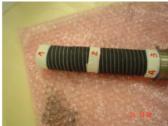
Figura 2. Foto da bobina supercondutora com etiquetas marcando as regiões 1, 2 e 3, de onde foram retiradas as amostras para o presente trabalho. A região 3 fica próxima aos contatos elétricos da bobina. O material supercondutor tem coloração negra. Entre as espiras supercondutoras observa-se o material isolante (listras azuis).
