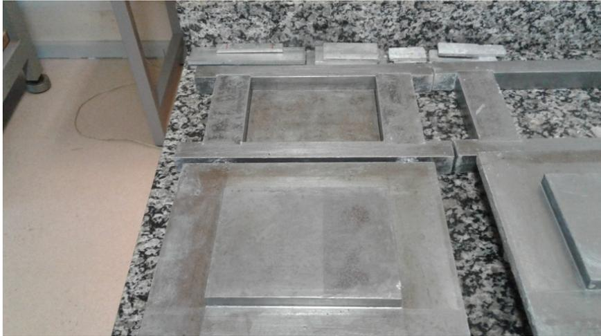
Figura 3. Molde metálico para confecção do compósito
