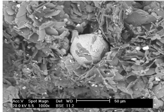
Figura 8. Partícula de aço solidificado na parte intermediária do depósito.
