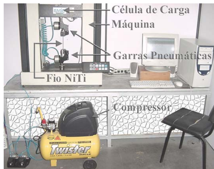
Figura 2 – Máquina de ensaios universais EMIC DL 500 equipada com acessórios para ensaio de tração de fios de NiTi no LAFUN/UFRGS.
