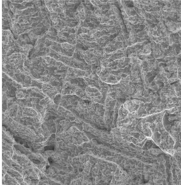
**Figura 4**– Superfície da fratura do CP 1, 200X, elétrons secundários (SE).
