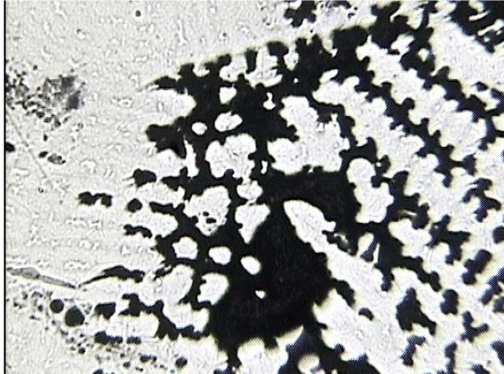
**Figura 2** – Aspecto micrográfico da liga FIT- FLEX. Ataque: Persulfato de amônia, aumento: 500X.
