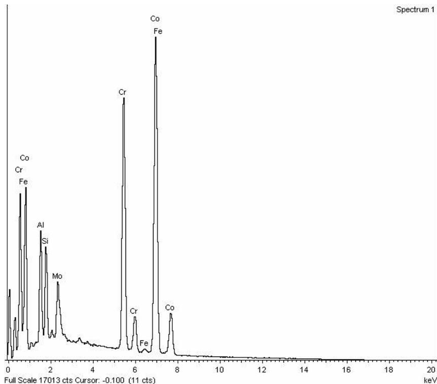
**Figura 7** – Espectro de EDS típico mostrando a presença dos elementos Co, Cr, Al, Mo, Si e Fe em picos significativamente elevados.
