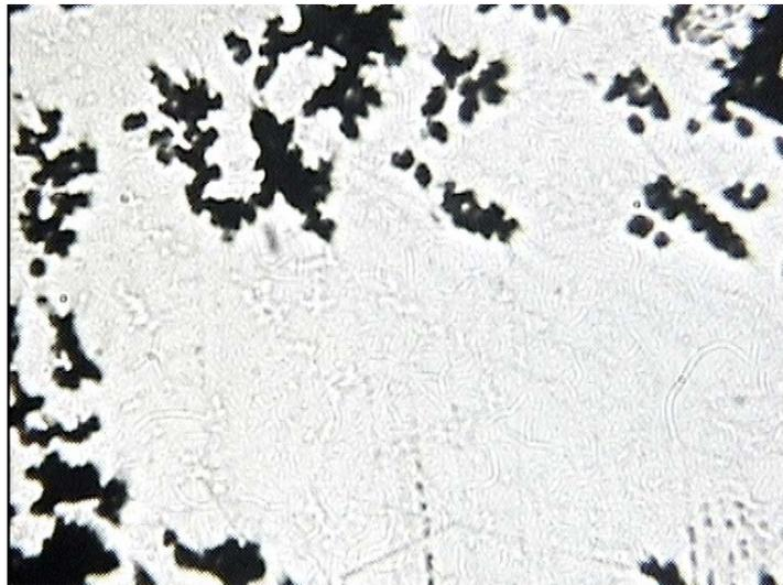
**Figura 3** – Aspecto micrográfico da liga FIT- FLEX. Ataque: Persulfato de amônia, aumento: 500X.
