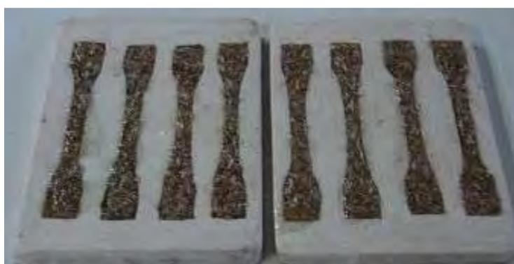
**Figura 3.** Fibras sisal nos moldes de silicone
