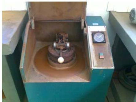
**Figura 5.** Pulverizador.
