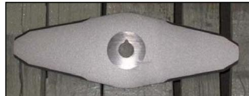
Figura 5. Navalha depois do processo de *shot peening*.
