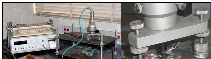
Figura 6: Sistema de medição utilizado e detalhe do processo de furação.
