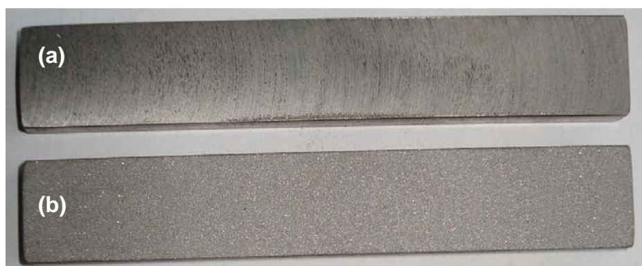
Figura 3. Aspecto da amostra utilizada: (a) amostra usinada; e (b) amostra jateada.
