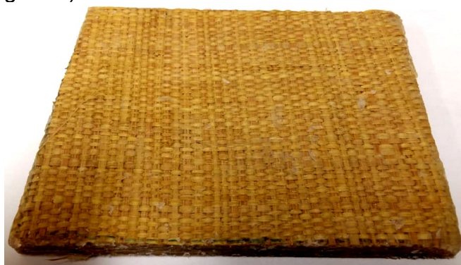
Figura 2. Compósito epóxi com tecido de buriti que foi retirada a fração para analisar no MEV.
