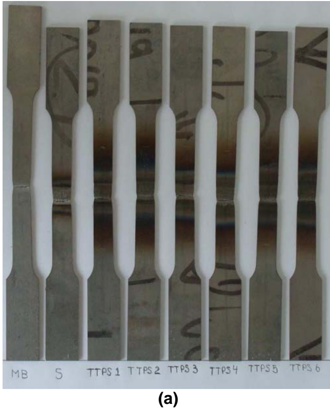
Figura 10: Corpos de prova de tração com ruptura na região da solda.
