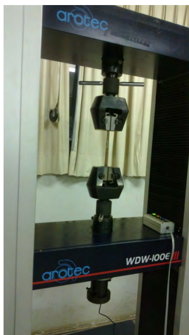
Figura 2 – Máquina Universal de Ensaio WDW-100E, Laboratório de Resistência dos Materiais – IFPA.
