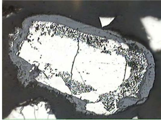
**Figura 3** – Fotomicrografia de uma partícula de liga FeMnAC agregada à escória. Aumento: 220x
