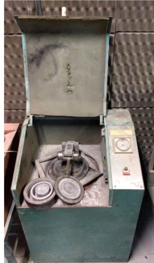
**Figura 3.** Moinho de argolas utilizado para preparação das amostras
