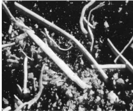
Figura 10: Micrografia da amostra de fibra de coco.<sup>(12)</sup>
