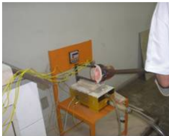
Figura 2. Vazamento do metal líquido na lingoteira do dispositivo de solidificação.
