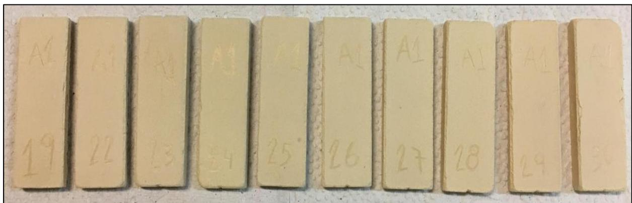
**Figura 3** – Corpos Cerâmicos sinterizados na Temperatura de 950°C.
