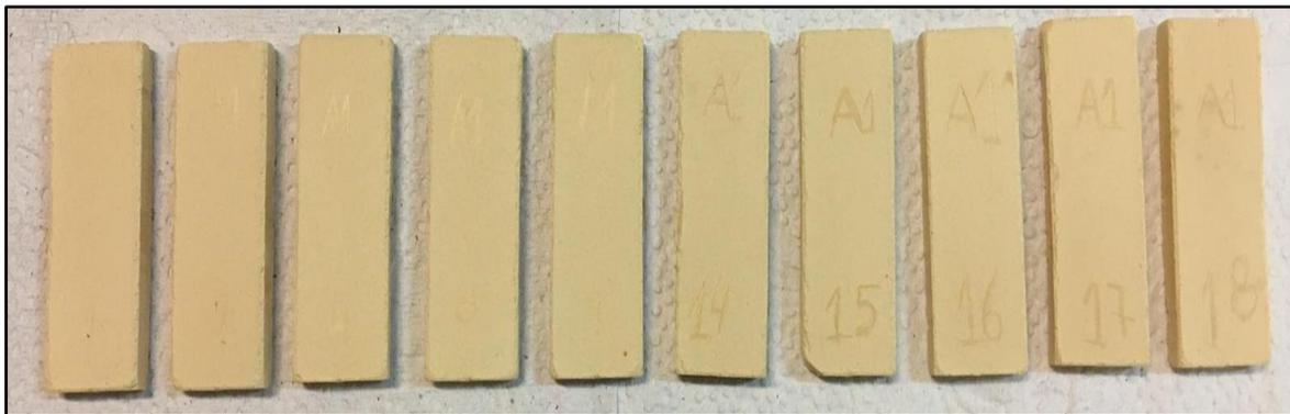
Figura 4 – Corpos Cerâmicos sinterizados na Temperatura de 1050°C.
