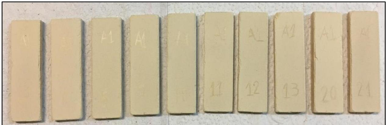
**Figura 2** – Corpos Cerâmicos sinterizados na Temperatura de 850°C.
