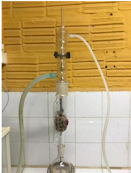
Figura 1. Equipamento Soxhlet montado. Fonte: Autores (2019)
