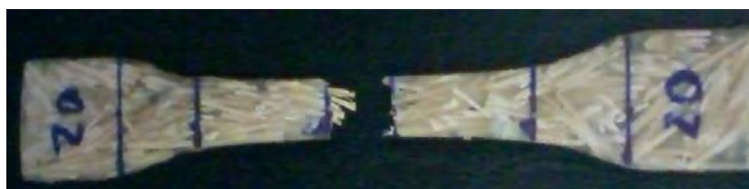
Figura 9. Corpo de prova rompido.
