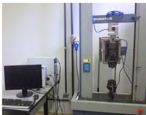
Figura 8. Máquina de ensaio de tração.
