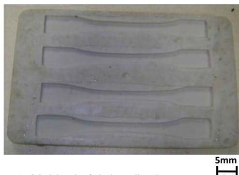
Figura 3. Molde de fabricação dos corpos de prova.
