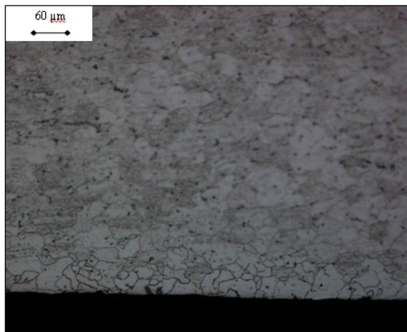
Figura 2. Mostra imagem do SAE 1006 com Ti que sofreu aquecimento a 700°C durante 10 minutos.
