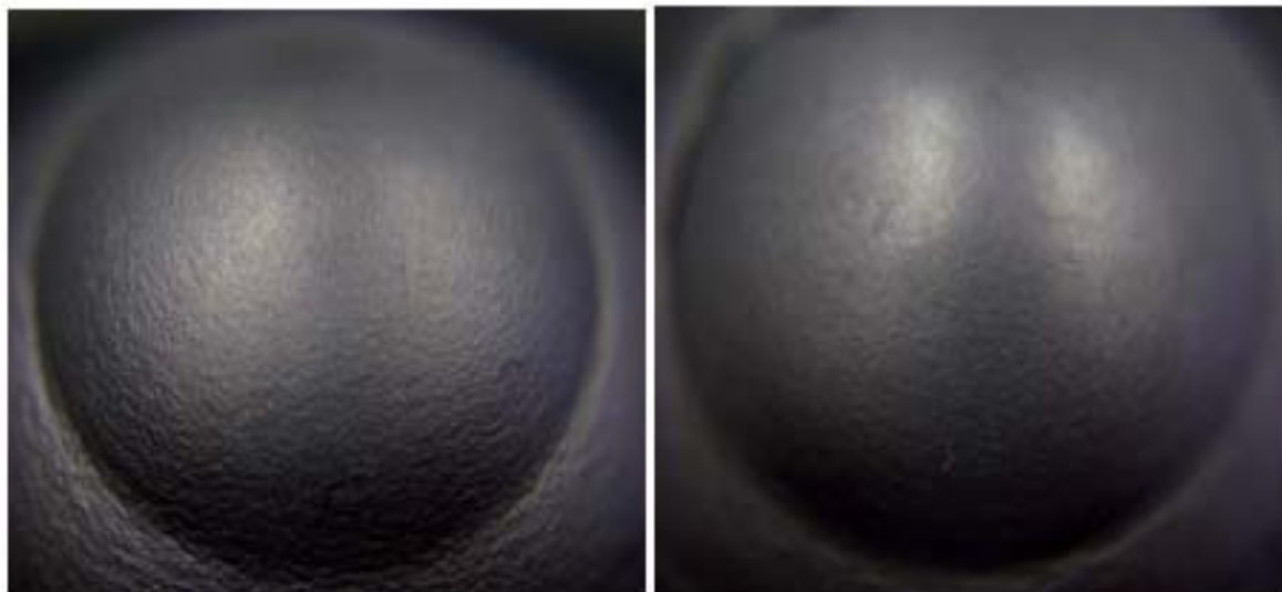
Figura 4. Aspecto visual das calotas SAE 1006 comum (esq.) e SAE 1006 com Ti (dir.), ambos a 800°C.
