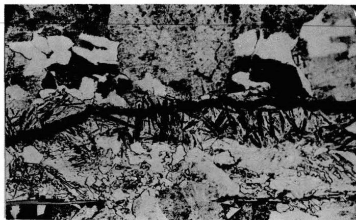
Fig.06 - Estrutura metalográfica da região defeituosa. 500x
