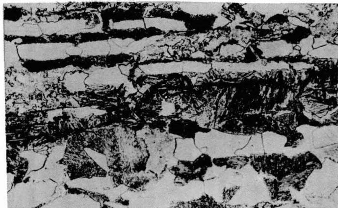
Fig.05 - Estrutura metalográfica da região defeituosa. 500x
