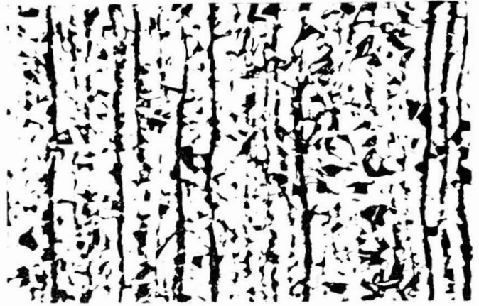
Fig.12- Estrutura metalográfica a 1/2 da espessura - 100 x
