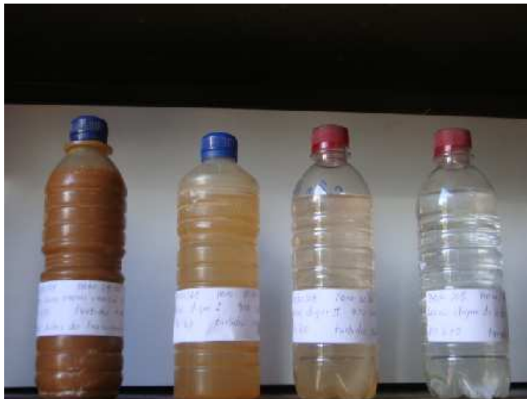
Figura 9. Amostras de água coletadas na sequência do processo de clarificação: 1ª antes do tratamento, 2ª no dique 01, 3ª no dique 02 e 4ª no dique de pedra.
