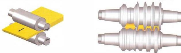
Figura 2. Conformação mecânica por meio de cilindros de laminação [2]
