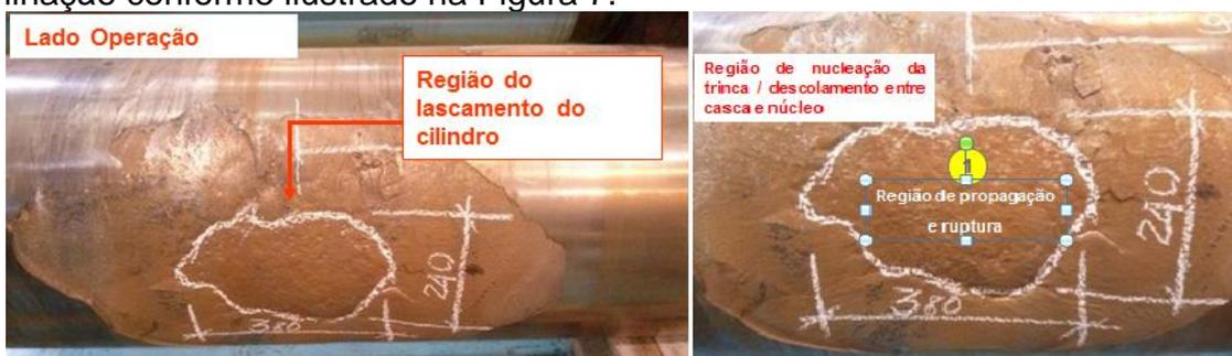
**Figura 7.** Lascamento do cilindro superior tipo FW2 – Fonte: ArcelorMittal Tubarão
