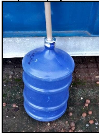
Figura 4 - Galão para captação da amostra de água
