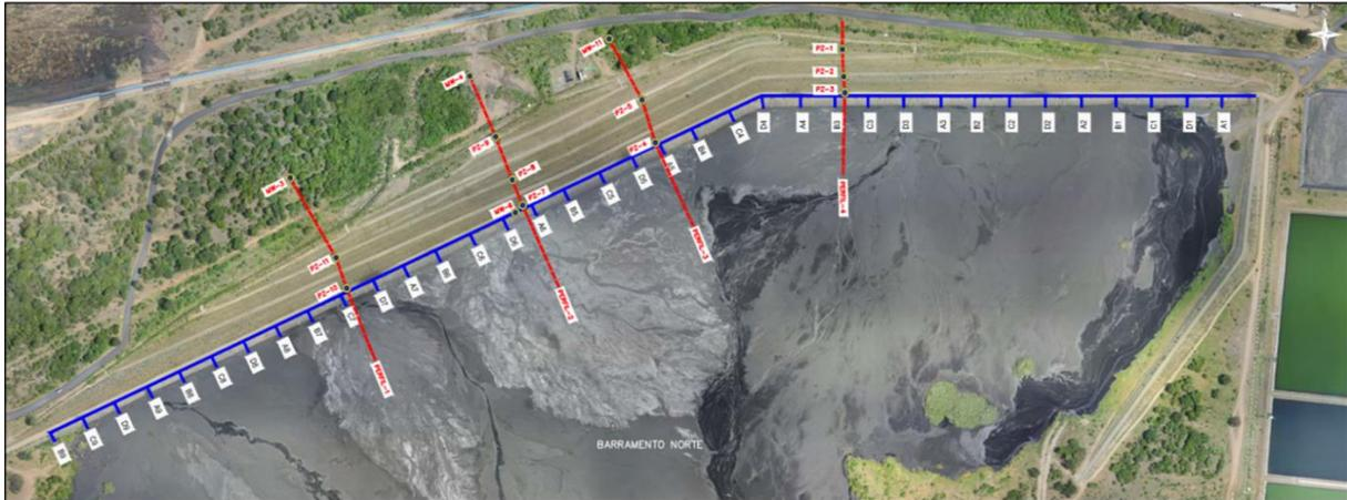
Figura 2-2 - Vista das linhas de lançamento de rejeitos e localização dos spigots
