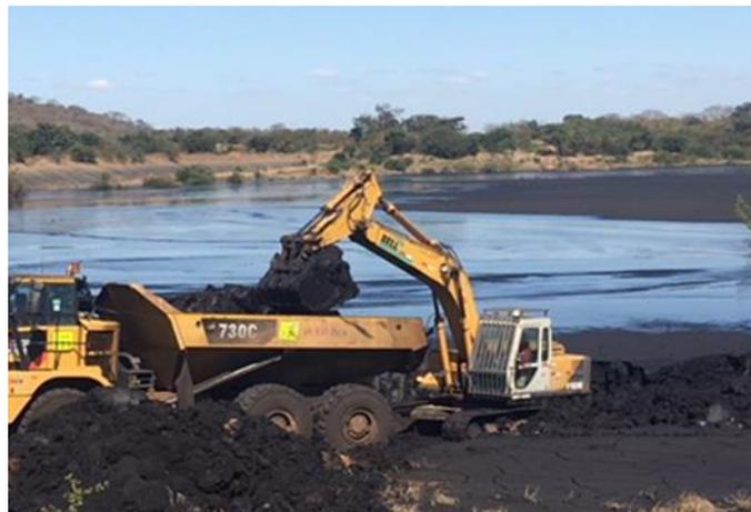
Figura 2-3 - Operação de lavra mecanizada da barragem de rejeitos visando incorporação do material ao produto térmico de exportação após secagem ao sol
