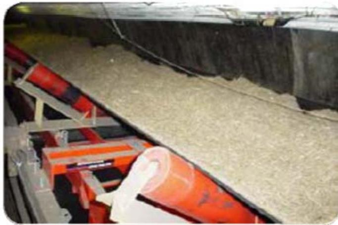
Figura 18. Balança pesando cavaco de madeira.
