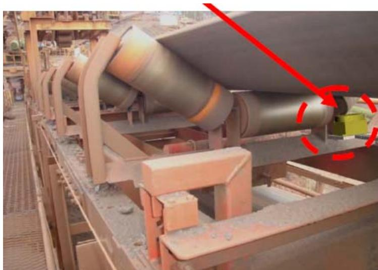
**Figura 1.** Medição de tensão da correia.
