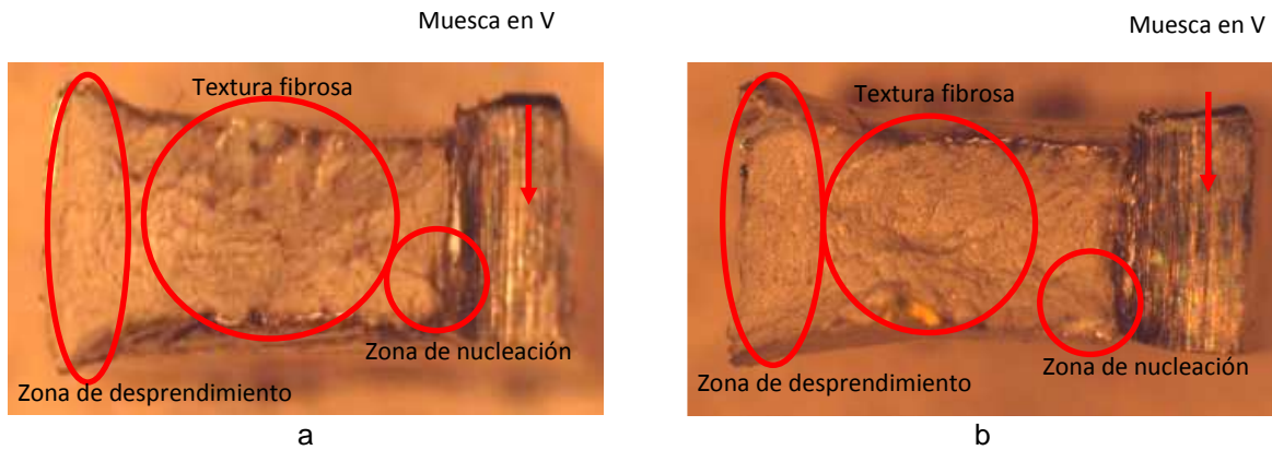
Figura 11. Superficies de fractura en las probetas de impacto, (a) SMAW 8X, (b) GMAW 8X.
