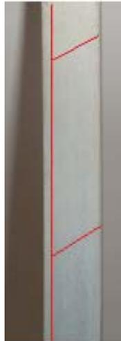
Figura 3. Marcas na amostra para interferometria.
