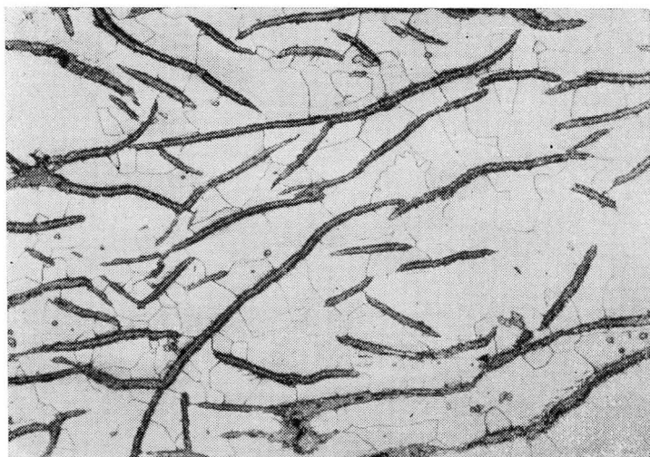
Fig. 5 — Micrografia da lingoteira n.º 6 (procedência B). Seção transversal no meio da parede; 100 ×; ataque Nital.
