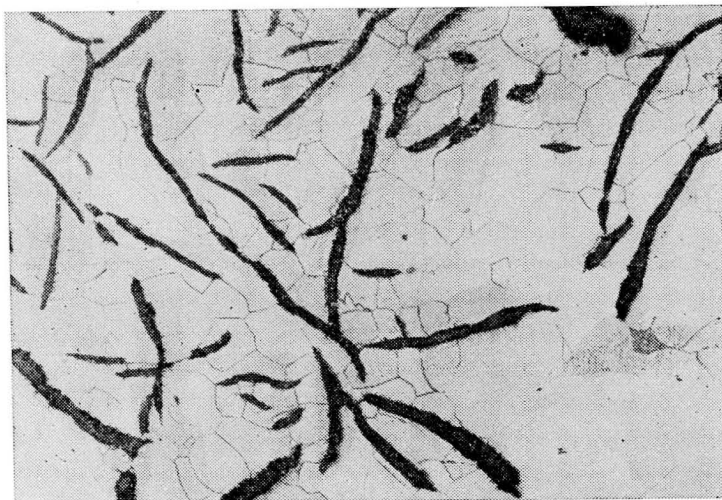
Fig. 2 — Micrografia da lingoteira n.º 1 (procedência A). Seção transversal no meio da parede; 100 ×; ataque Nital.
