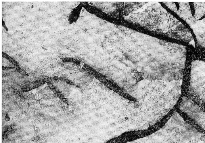
Fig 7 — Micrografia da lingoteira n.º 7 (procedência B), que apresenta trinca de tensão interna após a 1.ª corrida; 250 x; ataque Nital.
