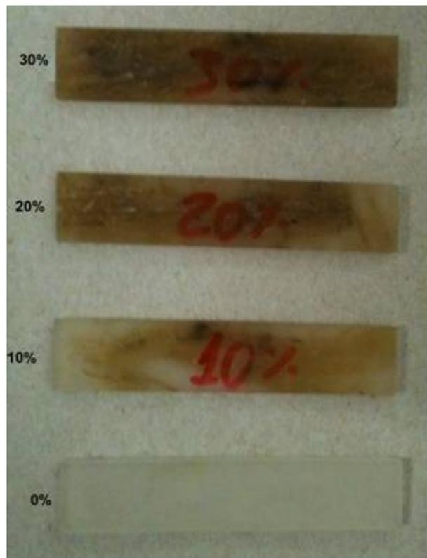
**Figura 3.** Corpos de prova de DMA com fibras de bananeira e resina poliéster.
