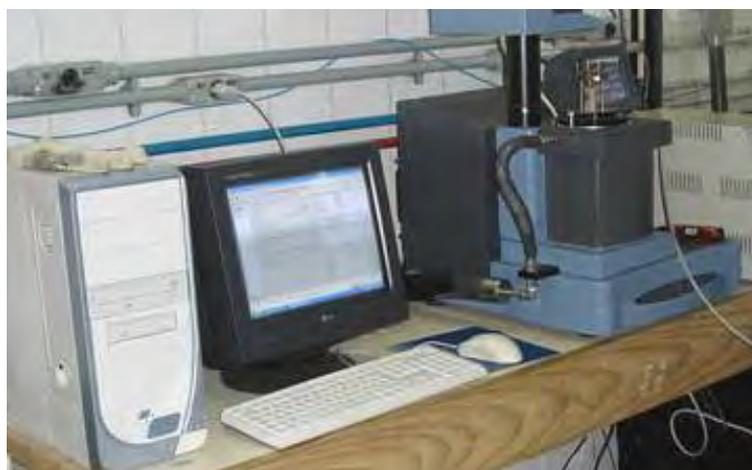
**Figura 2.** Equipamento de DMA do IMA/UFRJ utilizado nesta investigação.
