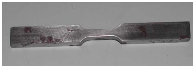
Figura 1. Geometria dos corpos-de-prova empregados nos testes de tração e fadiga.
