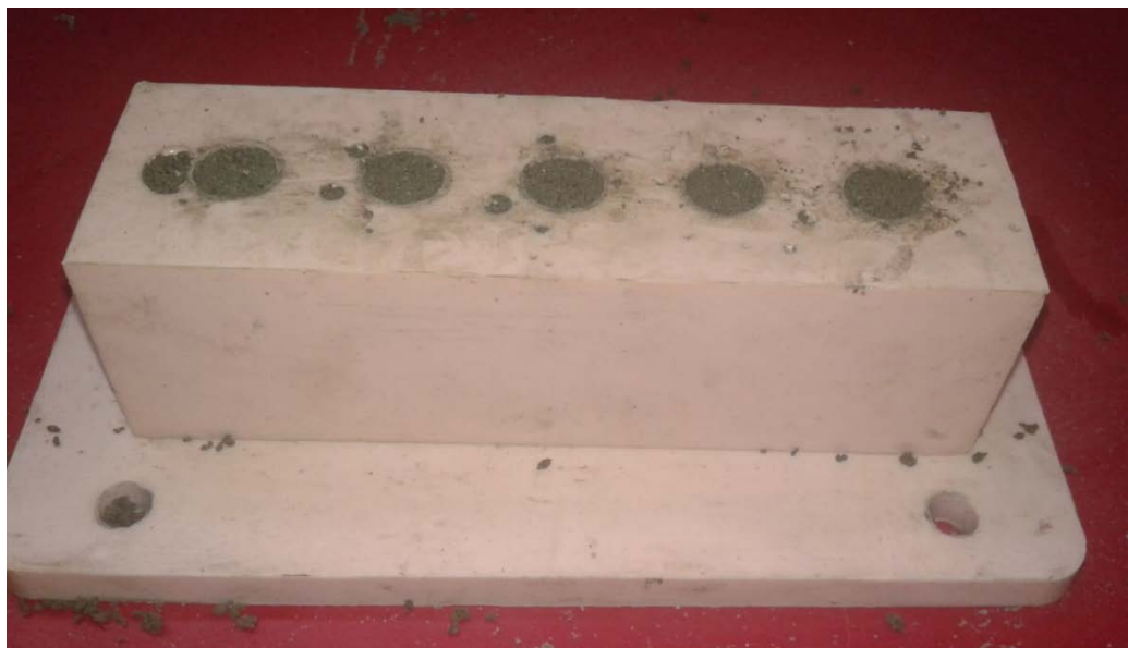
Figura 3. Detalhe de corpos-de-prova cilíndricos após sua moldagem em molde de silicone.
