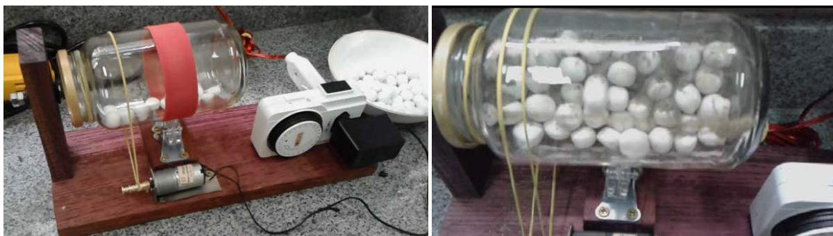
Figura 2. Detalhe do moinho de bolas: (a) apenas com as esferas de alumina; (b) com cimento, areia, grafeno e esferas de alumina em seu interior.
