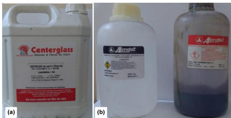
Figura 1. Matriz polimérica: (a) Resina; (b) iniciador MEK-P e acelerador de cobalto.
