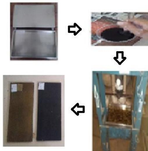
Figura 3. Sequência da produção dos compósitos.
