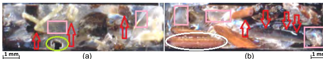
Figura 7. Microestrutura de um corpo de prova de 50% piaçava, 50% sisal com fibras de 10 mm. (a) Corpo de maior resistência à tração; (b) Corpo de menor resistência à tração.
