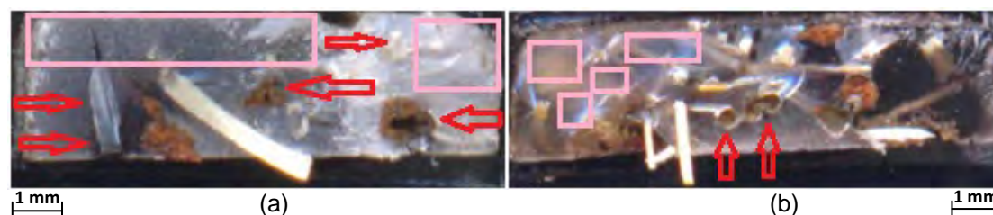
Figura 8. Microestrutura de um corpo de prova de 50% piaçava, 50% sisal com fibras de 15 mm. (a) Corpo de maior resistência à tração; (b) Corpo de menor resistência à tração.
