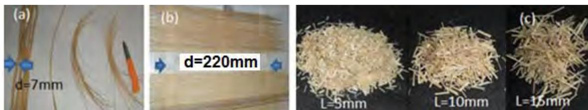
**Figura 5** – Amostras das fibras : (a) o cipó e as fibras extraídas; (b) fibras alinhadas para confecção dos corpos de prova; (c) Fibras com comprimentos de 5, 10 e 15 mm para fabricação dos corpos de prova dos compósitos.
