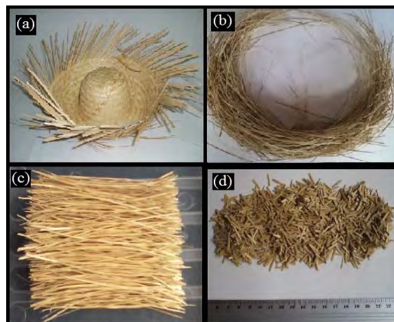
Figura 5. (a) Chapéu de palha da fibra de carnaúba, (b) e (c) Tamanho de espessura reduzido e (d) Fibras cortadas com tamanho reduzido desejado para a fabricação do compósito.
