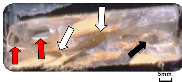
Figura 12. Superfície fraturada de compósito poliéster reforçado com fibras de carnaúba de 5 mm.
