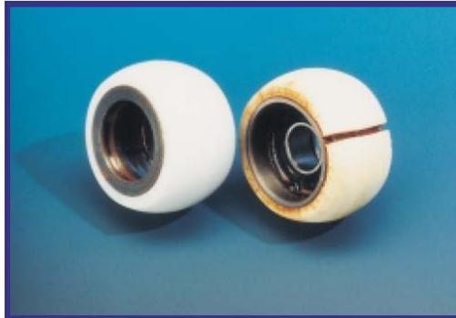
**Figura 3.** Degradação do material devido ao excesso de radiação UV.<sup>(3)</sup>
