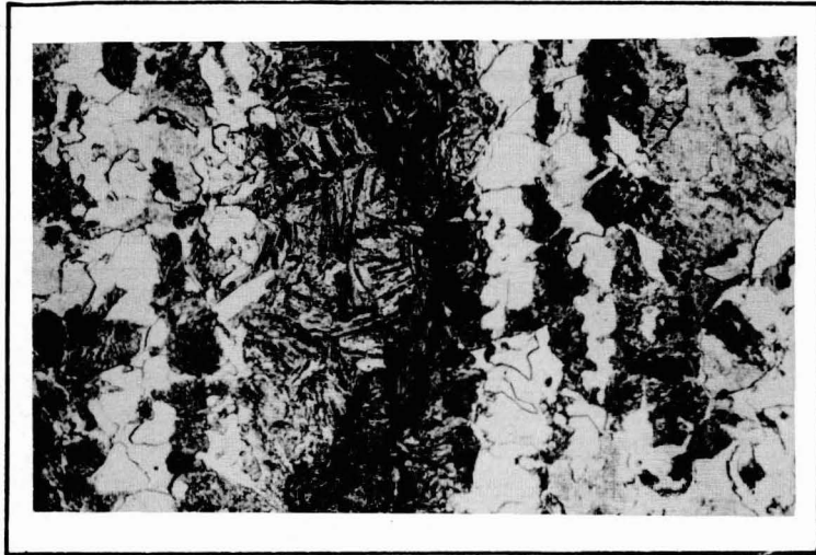
FIG. 2 - ESTRUTURA METALOGRAFICA DA REGIÃO SEGREGADA. Nital 4% .500x (1)
